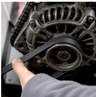
Рисунок 17. Проверка натяжения ремня генератора
